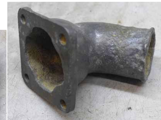
Effect van corrosie op achterdeksel kop (links) en thermostaathuis (rechts).
