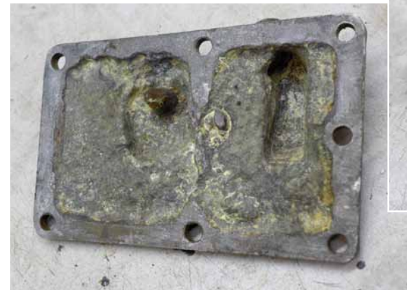
Effect van corrosie op achterdeksel kop (links) en thermostaathuis (rechts).
