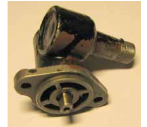
Haakse overbrenging moet afgedopt worden.
