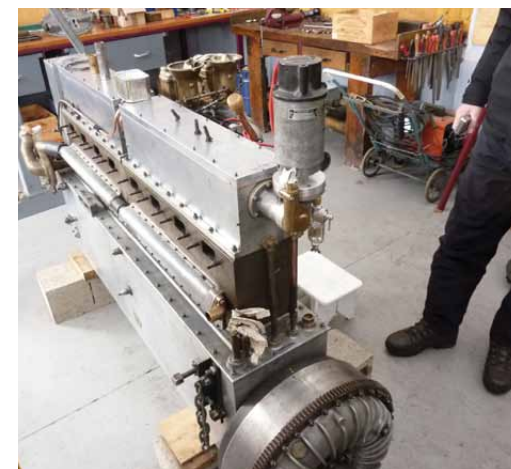
Bugatti Royale motor, bijna klaar voor proefloop
