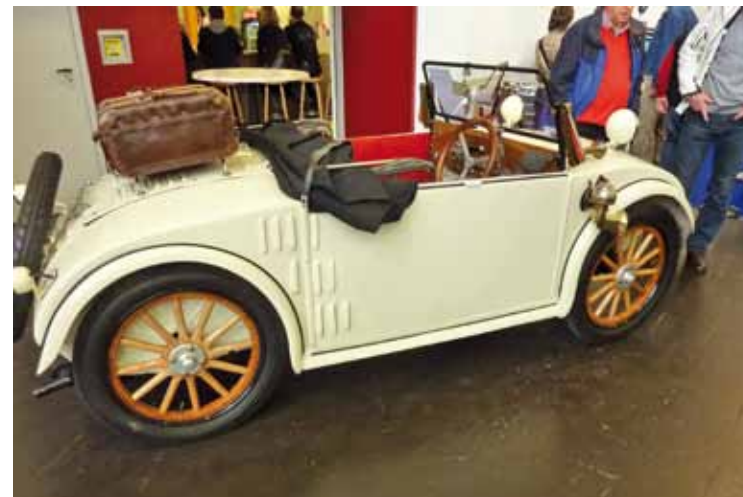
De Hanomag Kommisbrot, een 1-cylinder in de koffer, de koffer er boven op.. simpel maar leuk.
