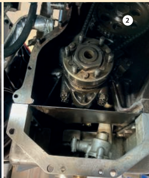
Rückseite des Motors nach Abschrauben des hinteren Motordeckels, der den Simmering enthält.
