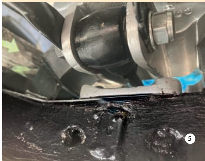
Sporen aan versnellingsbaksteun van aanslag door te oude rubbers. Spuren am Getriebehalter vom Aufschlagen durch zu alte Getriebehaltergummis.
