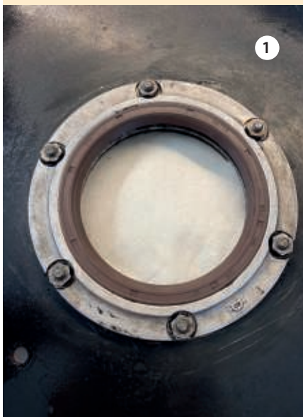
Oliekeerring vliegwielzijde krukas. Simmering am Ende der Kurbelwelle.
