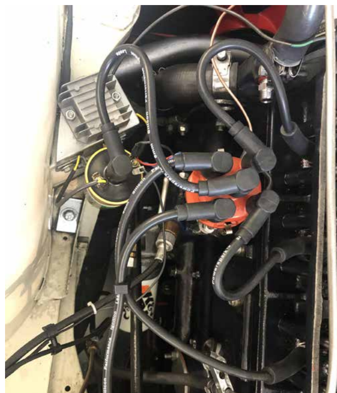
Spanningsstabilisator in de TR - linksboven op de foto Spanningskonstanthalter im TR - links oben im Bild
