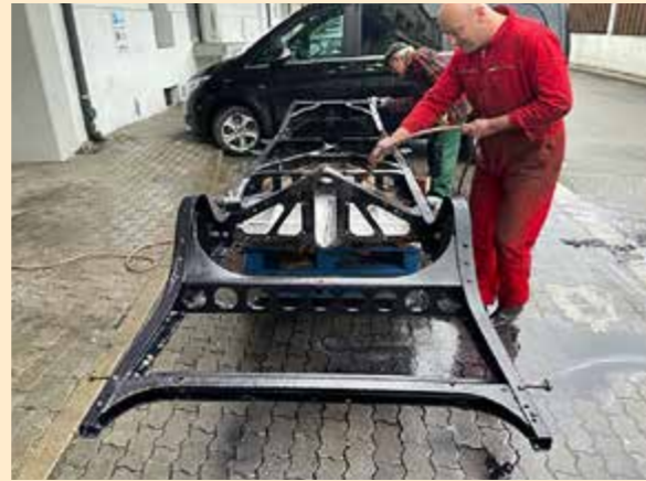
Roestwerende behandeling na de frame reparatie. Het frame ziet er al heel goed uit.
