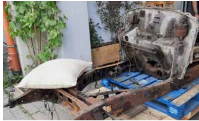
Toestand van het frame en het schutbord voor het zandstralen. Zustand des Rahmens und der Firewall vor dem Sandstrahlen.
