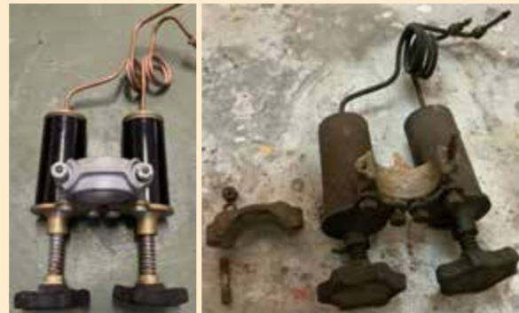
Restauratie resultaat voor - na bij het voorbeeld van de "Andre Hartford telecontrol" versteleenheid.
