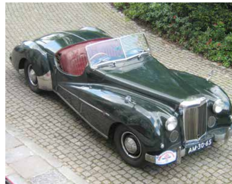
Tweemaal TB14 en éénmaal TB21, Meest opvallende uiterlijke verschillen zijn de verschillende radiator grilles, de vooruit en de wielmaat (TB14 heeft 16" en de TB21 15" wielen).
