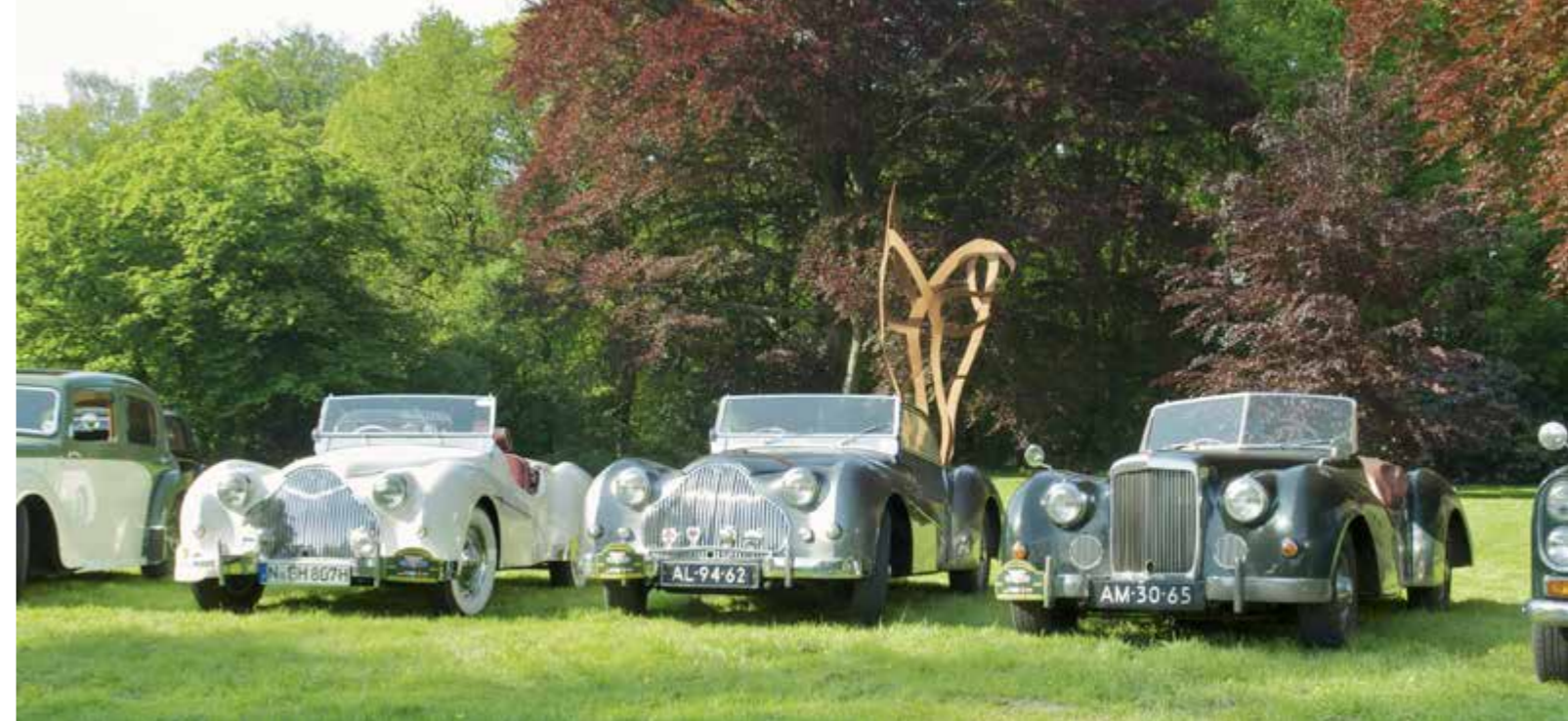
Tweemaal TB14 en éénmaal TB21, Meest opvallende uiterlijke verschillen zijn de verschillende radiator grilles, de vooruit en de wielmaat (TB14 heeft 16" en de TB21 15" wielen).
