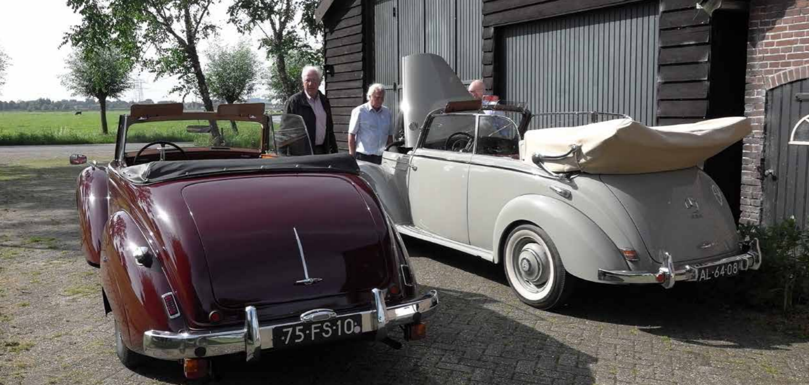
Twee verschillende manieren om de kap op te bergen
